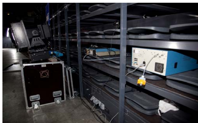
Le point de mesures « régie » en haut à gauche ; les points « fosse » en haut à droite (C, encastré dans les gradins repliés) et ci-contre (B, où les appareils ont été installés sous les gradins avec prélèvement au niveau des sièges des spectateurs)
