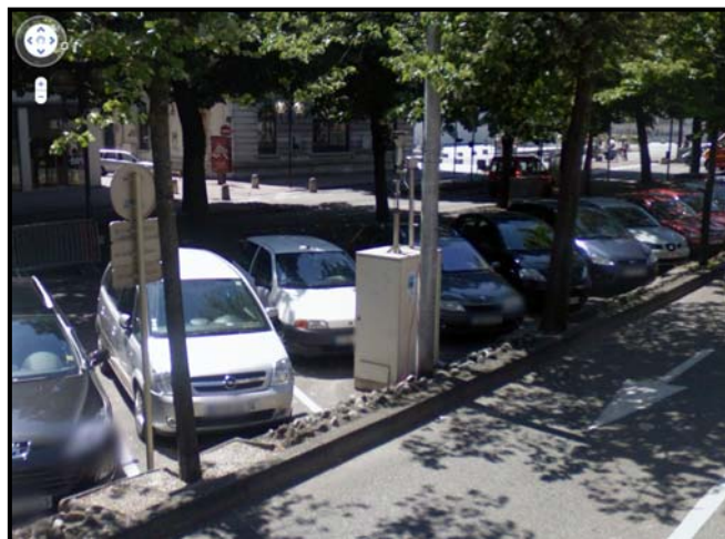
Cabine de mesures en proximité trafic: Boulevard du musée à Chambéry Coordonnées (UTM31 727916;5050260)
