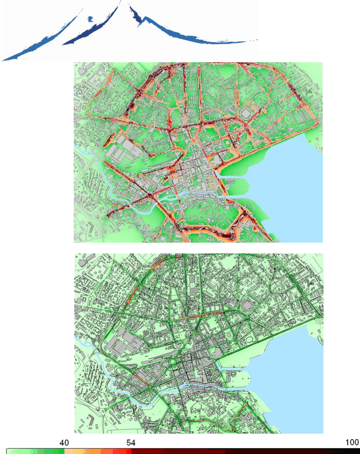
Figure 6 - Modélisation du dioxyde d'azote en moyenne annuelle pour l'année 2003 en haut et l'année 2008 en bas en utilisant l'échelle « réglementaire » de 2003 ( \mu\text{g.m}^{-3} ).
