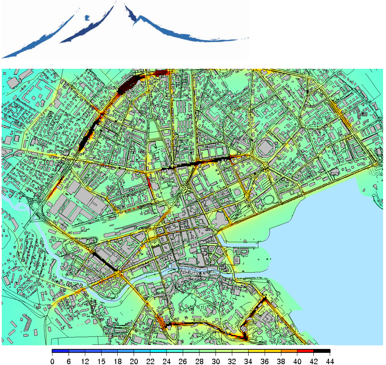
Figure 3 - Modélisation du dioxyde d'azote en moyenne annuelle pour l'année 2008 ( \mu\text{g.m}^{-3} )
