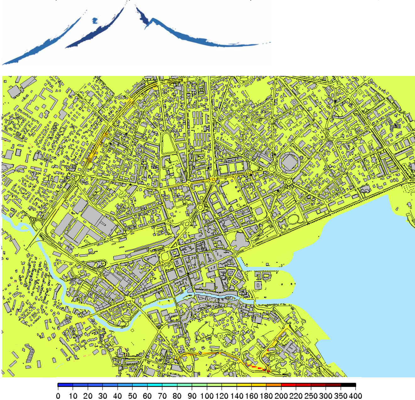
Figure 4 - Modélisation du dioxyde d'azote : maximum horaire modélisé pour l'année 2008 ( \mu\text{g.m}^{-3} )
