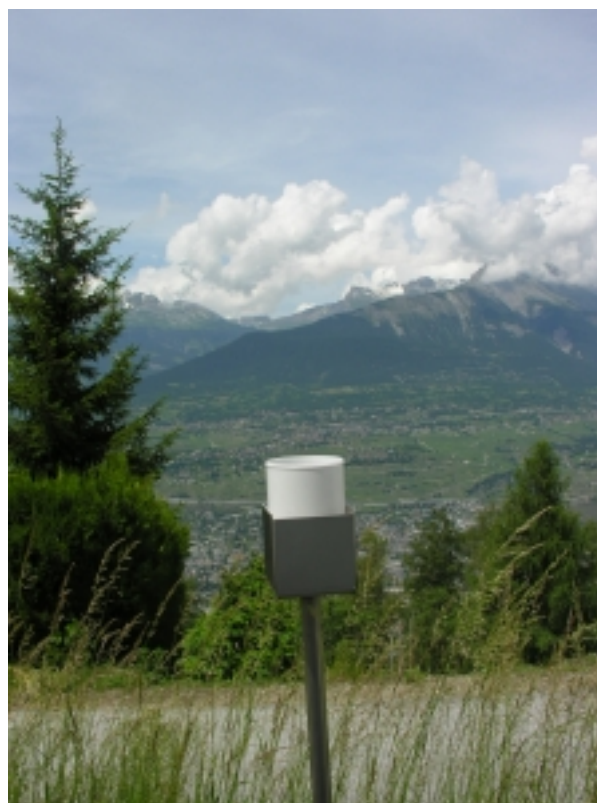
Figure 33 : Appareil de prélèvement Bergerhoff
